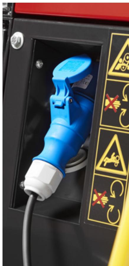
Chargeur intégré : 230V 16A 65V et câble
