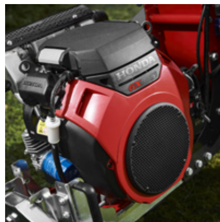
2-cilinder luchtgekoelde HONDA benzine-motor met elektronische ontsteking of B&S Vanguard-motor
