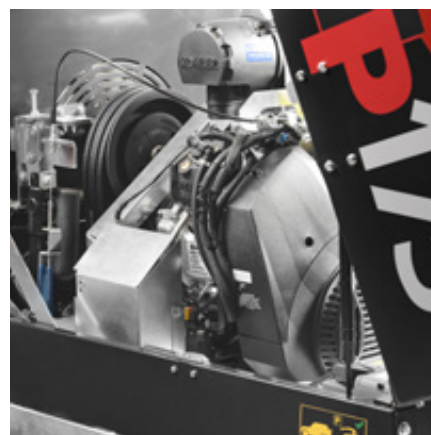
Potente motor Kohler EFI de 38 CV
