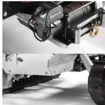
Cabrestante TP para superar terrenos inclinados. Mejor distancia al suelo del mercado: 200 mm. Anchura entre orugas: 1150-1300 mm. Protección de manguitos reforzada.
