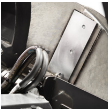
Dos cuchillos están constantemente en contacto con el material.
