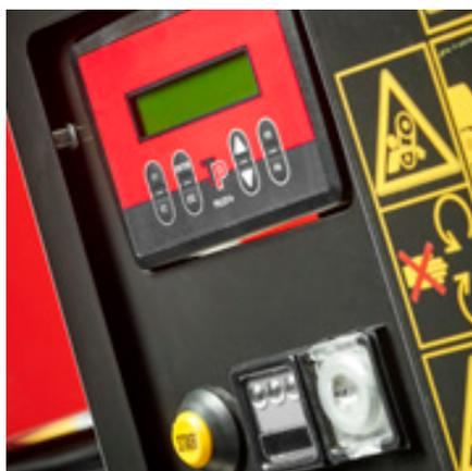
TP PILOT+ con TP Starter: sistema de embrague automático con correas de enganche/desenganche
