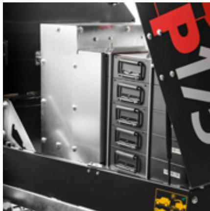
20 kWh (5 horas). La batería de litio (LiNiMnCoO2 65 V) proporciona hasta 5 horas de funcionamiento
