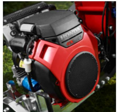
Motor de gasolina bicilíndrico HONDA refrigerado por aire con arranque electrónico o motor B&S Vanguard
