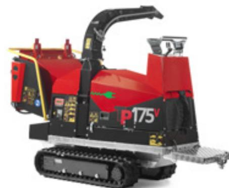
Panel de control manual y plataforma con interruptor de seguridad de 20 kg opcional
